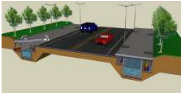
Gambar 3. 107 Tipikal Jaringan Listrik Bawah Tanah ( Box Utility ) dan PJU Solar Cell
